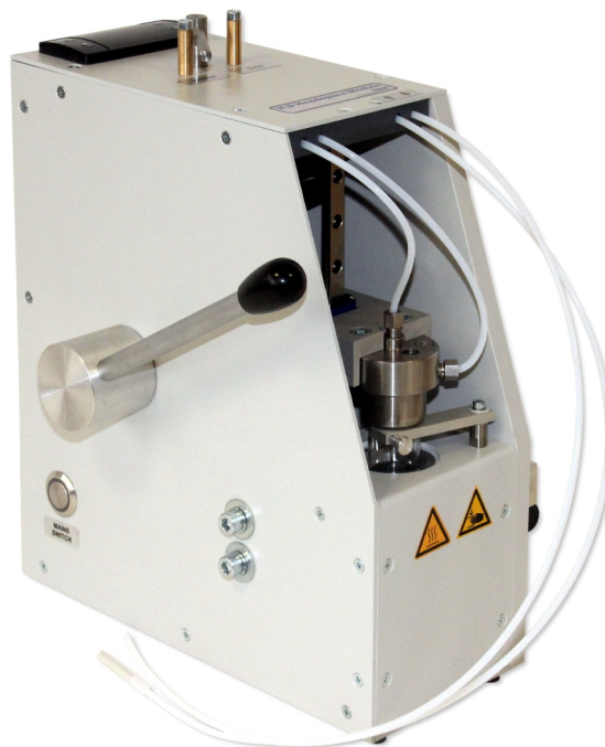
H 2 S-Headspace-Modul zur Ankopplung an Sulfimax-GX-Analysensysteme der ECH
