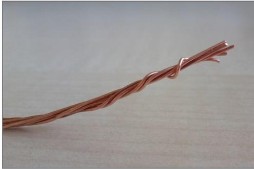
Anwendung: Kupferschicht auf Stahldraht
