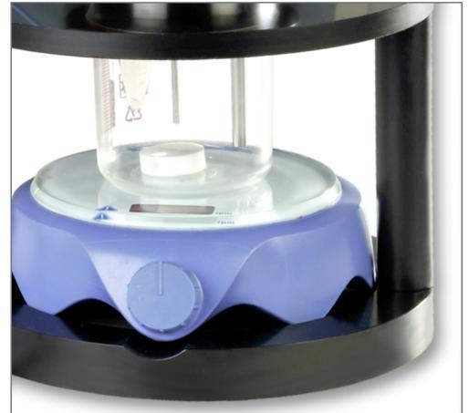
Coulometrische Messzelle - die Probe ist die Arbeitselektrode
