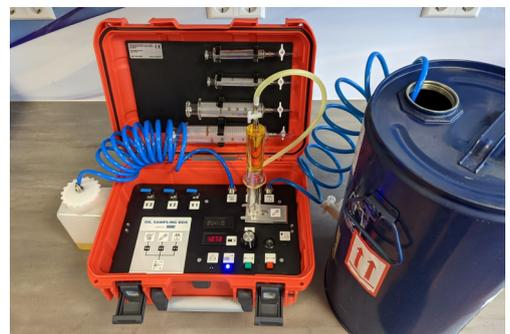
Einfache Probennahme von Gasen und Flüssigkeiten
