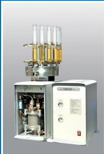
Kopplung des gas**extractors** mit dem Gaschromatograph im TOP TOGA GC
