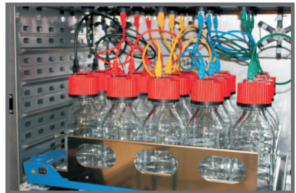
Gäransätze mit Sensorköpfen auf herausfahrbarem Magnetrührer
