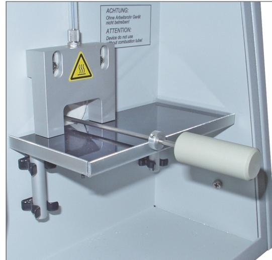
Probendosierung mit Schiffchen aus Keramik oder Quarzglas
