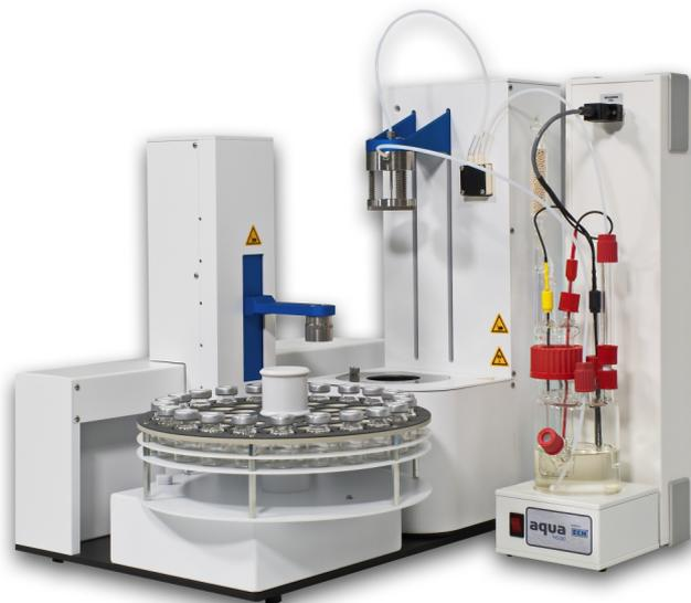
AQUA 40.00 Grundmodul erweitert zum AQUA 40.00 Vario PLUS, der automatischen Version mit Probengeber
